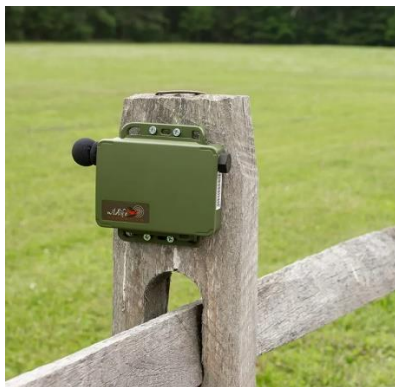
Le SM Mini de l'entreprise Wildlife Acoustics est un enregistreur autonome utilisé pour ce que l'on nomme « Passive Acoustic Monitoring (PAM) »
